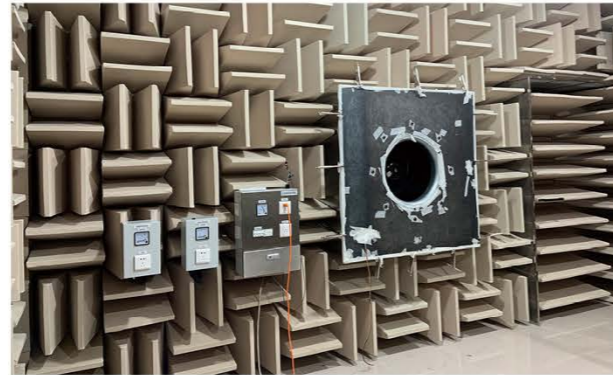
Fan noise test anechoic chamber
